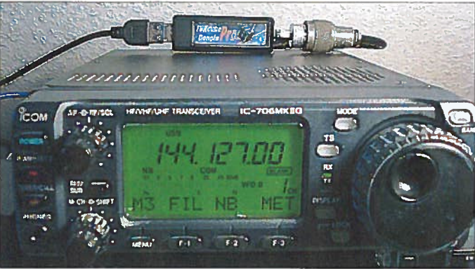
Bild 1: Das SDR FUNcube-Dongle Pro+ und der Transceiver Icom IC-706MKIIG in trauter Eintracht; an der richtigen Stelle angeschlossen bleibt der FCDPP auch im Sendebetrieb vor zu hohen Spannungen geschützt.
