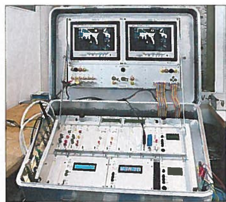
Eine komplette ATV-Station von der ATV-Arbeitsgemeinschaft in München e.V.; die einzelnen Baugruppen sind als Einschübe gestaltet, sodass die Station vielseitig einsetzbar ist.
