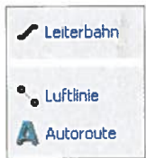
Bild 3: Die Buttons der Werkzeuge Leiterbahn , Luftlinie und Autorouter befinden sich in der linken Werkzeugleiste.
