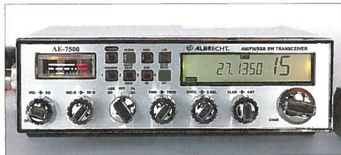
Der AE-7500 von Albrecht ist ein 11-m-CB-Mobiltransceiver für SSB, AM und FM. Funkamateure können das Gerät auch im 12-m- und 10-m-Band betreiben.
