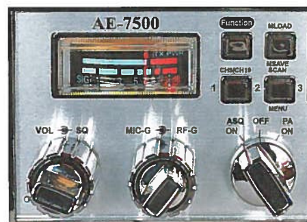
Ein analoges Zeigerinstrument dient u. a. als S-Meter. Wesentliche Einstellparameter sind direkt über Drehknöpfe zugänglich. Fotos: DL1ABJ
