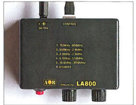
Bild 4: Die aktive LA800DX empfängt durchgehend von 10 kHz bis 500 MHz (Verstärkung bis 10 dB) und lässt sich von 150 kHz bis 30 MHz (Verstärkung mindestens 20 dB) zusätzlich abstimmen.
