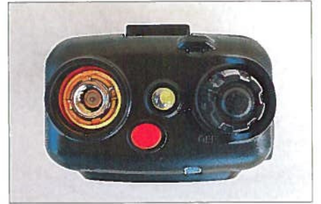
Bild 9: Die Oberseite teilen sich eine versenkte Reverse-SMA-Buchse, eine weiße LED als Taschenlampenersatz, der mit dem Ein-/Ausschalter kombinierte Lautstärkedrehknopf, eine orangefarbene Alarmtaste und eine Öse für die Handschleife.
