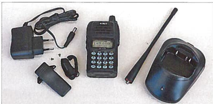
Bild 2: Zum Lieferumfang des DJ-A10E zählt auch eine Ladeschale mit Steckernetzteil. Laden lässt sich das Gerät nur in dieser Schale.
