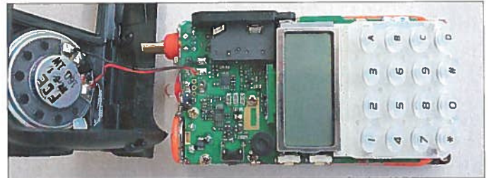
Bild 8: Der Blick ins Innere zeigt einen sauberen Aufbau mit einer umlaufenden Gummidichtung. Fotos: DG1NEJ
