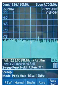
Bild 6: Störnebel am Metallstecker des HDMI-Kabels D
