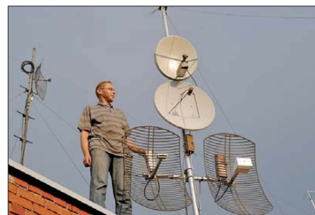
Ricardas, LY2FN, ist häufig an der Klubstation LY3V in Kaunas (KO14XV) QRV. Dort arbeitet er hauptsächlich auf den Mikrowellenbändern. Die Antennen sind auf dem Dach der örtlichen Universität angebracht, die Konverter befinden sich unmittelbar an den Spiegeln. Foto: SM0HJF
