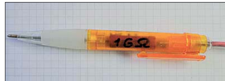
Bild 20: Mögliche Realisierung eines Hochspannungstastkopfs
