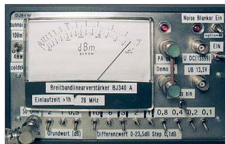
Bild 2: Rauschmessung beim Kabel A; 14,5 dB über Grundrauschen zum kalten Himmel
