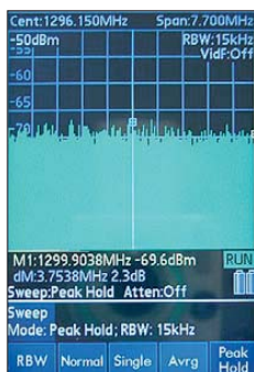
Bild 5: Störnebel am Plastikstecker des HDMI-Kabels A
