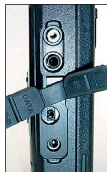
Bild 3: Ein ganzes Arsenal von Buchsen bietet die rechte Seite: für Mikrofon und Lautsprecher in bekannter Norm, Datenkabel und Lade- bzw.
