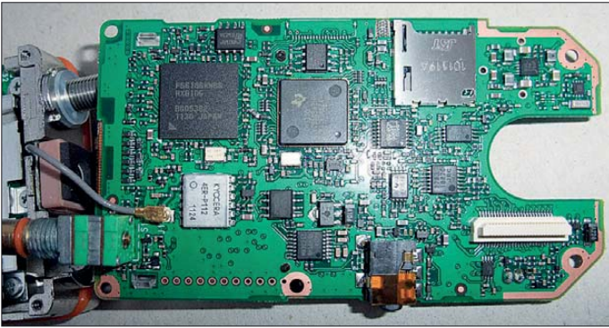
Bild 10: Der eigentliche Sende-/Empfangs- zug verschwindet unter einem großen Abschirmblech.
