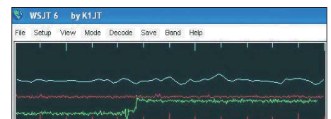
Bild 3: WSJT/JT65-Auswertung mit Störanstieg nach Einschalten des HDMI-Kabels A
