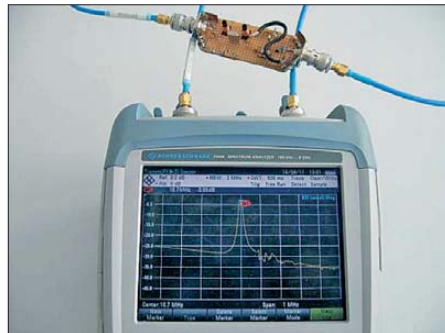
Bild 18: Messaufbau zur Bestimmung des Frequenzgangs des 10,7-MHz-Quarzfilters
