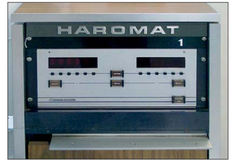
Der Haromat war das am Zuse-Rechner Z25 agierende Gegenstück zum Plotter.
