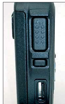
Bild 3: Ein ganzes Arsenal von Buchsen bietet die rechte Seite: für Mikrofon und Lautsprecher in bekannter Norm, Datenkabel und Lade- bzw.
