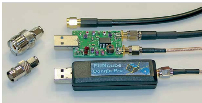
Bild 1: Der FCD (u.) besteht aus einem zweiteiligen Kunststoffgehäuse, das die Leiterplatte mit sämtlichen Bauelementen trägt. In der Bildmitte ist der KW-Konverter zu sehen, der als vorbestückter Bausatz geliefert wird.
