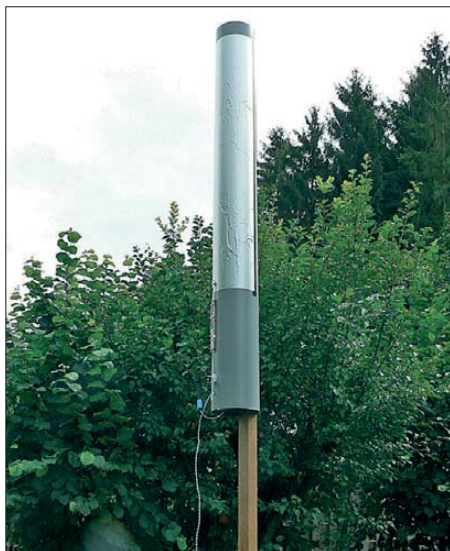
Bild 3: Bei Erhöhung des „Mindestabstands“ zur Erde ergibt sich keine signifikante Kapazitätsänderung, siehe Text.
