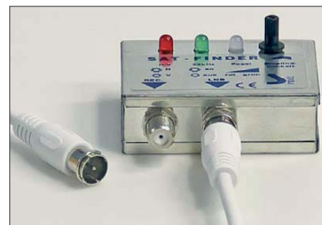
Bild 9: Der preisgünstige Sat-Finder wird am LNB in die Leitung zum Receiver bzw. zur Hausverteilungsanlage eingeschleift.
