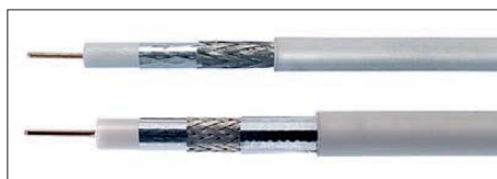
Bild 8: Das Koaxialkabel LCD89 (oben) von Kathrein eignet sich mit nur 5 mm Außendurchmesser zum Einziehen mehrerer Kabel in vorhandene Leerrohre. Das 7-mm-Kabel LCD111 (unten) bringt es auf 120 dB Schirmungsmaß.
