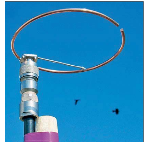
Bild 4: Testaufbau der fertigen Halo-Antenne an einem Besenstiel aus Holz; das Isolierband ist nur mit leichtem Druck um das Koaxialkabel gewickelt. Fotos: DH8AG
