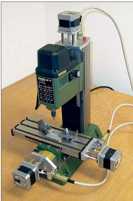
Bild 1: Komplett aufgebaute CNC-Fräse ohne Abdeckungen für X/Y-Antriebe
