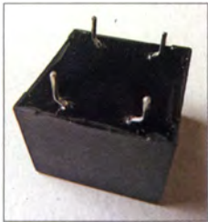
Bild 5: Die Anschlussbeine des neuen Übertragers werden um je 1,2 mm nach außen gebogen.
