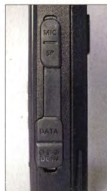
Die Einschalttaste ist nun auf die linke Seite gewandert. Unter der Abdeckung befindet sich der Steckplatz für eine Micro-SD-Speicherkarte.
