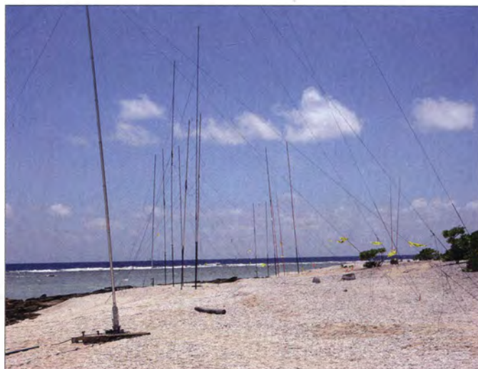
Eine der beiden Antennenfarmen von NH8S; die unmittelbar am Salzwasser aufgestellten Vertikalantennen gewährleisteten die erwünschte Flachstrahlung.
