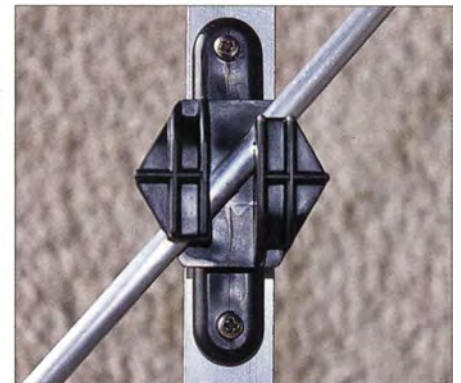
Bild 16: Im 45°-Winkel eingesetzt und durch eine Rechtsdrehung eingeklemmt halten die Elemente ohne weitere Befestigung.
