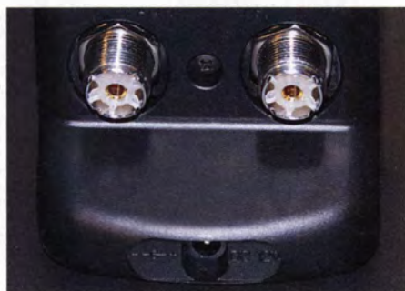
Bild 2: Die Rückseite mit den Koaxialbuchsen und der 12-V-Zuführung Fotos: DK7ZB
