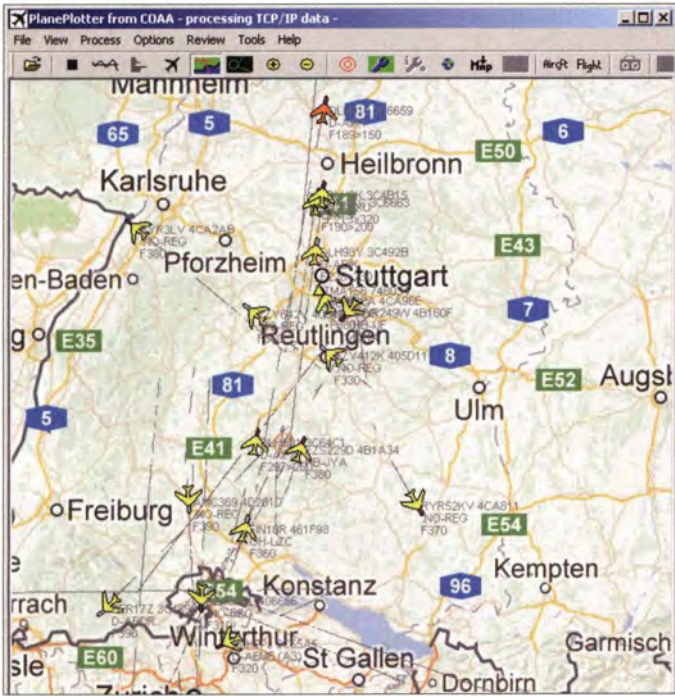
Bild 7: Flugzeugsymbole zeigen in der Kartendarstellung die jeweilige Position und Flugrichtung an. Zu sehen sind auch Kennung, Flugnummer und Flughöhe. Gelbe Symbole zeigen aktuell empfangbare Flugzeuge. Symbole in Orange gehören zu errechneten Positionen von Flugzeugen, die den Empfangsbereich bereits verlassen haben.
