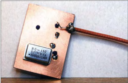
Bild 13: Das Muster des Kalibriergenerators wurde mit einem CMOS-Quarzoszillator auf- gebaut, der auf 3,5795 MHz arbeitet.
