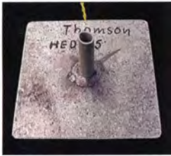
Bild 8: Auf das 50 mm x 50 mm große Weißblech ist in der Mitte ein kleines Loch anzubringen und ein dünner Stutzen zu löten.
