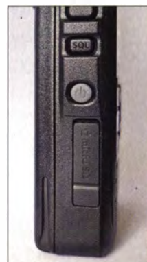
Die Einschalttaste ist nun auf die linke Seite gewandert. Unter der Abdeckung befindet sich der Steckplatz für eine Micro-SD-Speicherkarte.
