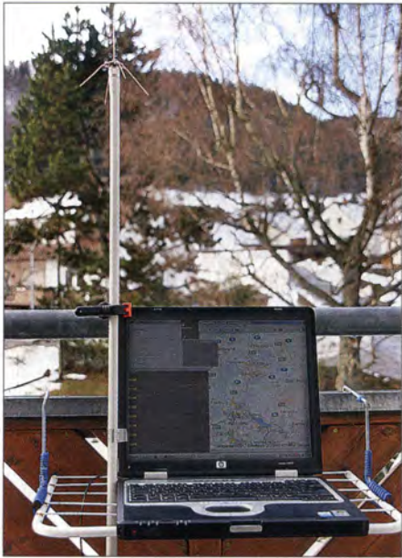
Bild 9: Bei der Erprobung waren trotz eingeschränkter Sicht zahlreiche Flugzeuge aus über 100 km Entfernung empfangbar.
