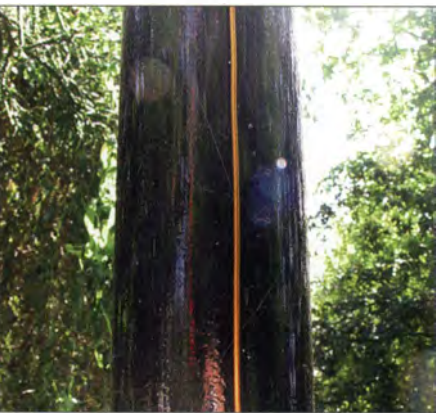
Bild 1: Strahler aus Kupferlackdraht, entlang eines 18-m-GFK-Masts geführt Foto: DK5WL
