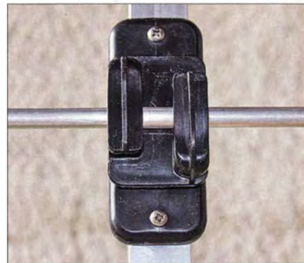
Bild 15: Halterung der 8-mm-Elemente mit Weidezaun-Isolatoren; hier kam der Typ 3 zum Einsatz.
