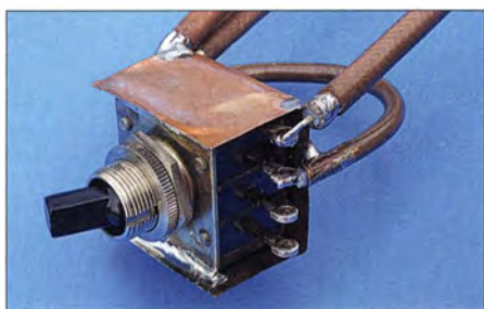
Bild 1: Kippschalter zur Antennenumschaltung; die aus dünnem Kupferblech angefertigte U-förmige Abschirmung ist mit je einer Längsnaht an die Metallplatte des Kippschalters gelötet.
