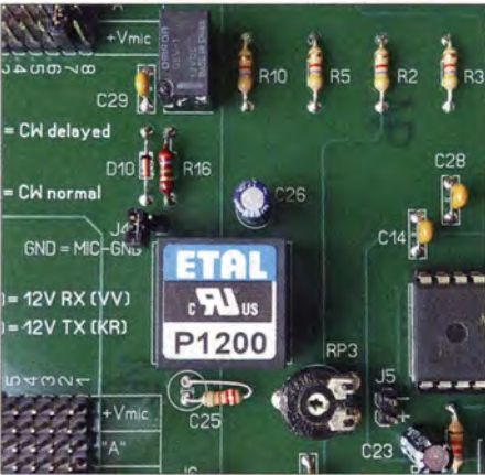
Bild 9: FA-SM-Platine mit dem neuen Übertrager R16 sowie R19 anstelle von C25. Fotos: DH2MIC (4), Red. FA (1)
