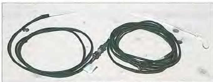
Bild 6: Als Alternative zur mitgelieferten Gummiwendelantenne bewähren sich J-Antennen; hier ein Exemplar fürs 70-m-Band mit Anschluss- und Verlängerungskabel.
