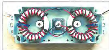
Bild 3: ... und der zweistufige Aufbau mit großen Ringkernen von 60 mm Außendurchmesser
