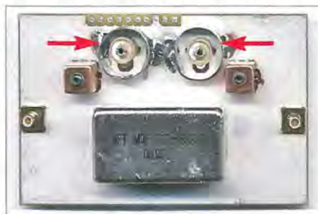
Bild 1: Oberseite der Filterplatine u. a. mit den abgeschirmten Trimmerkondensatoren
