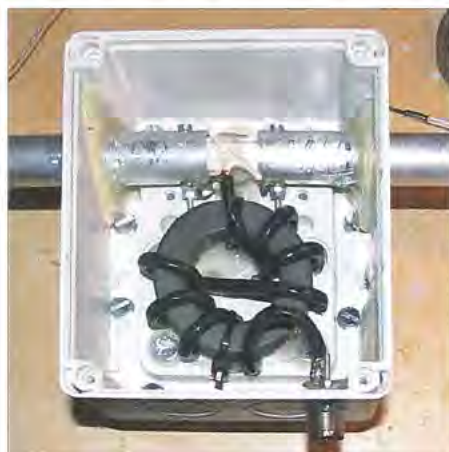
Bild 5: 1:1-Strombalun nach W1JR in der Anschlussdose Fotos: DH8BQA (2), DK7ZB (2)
