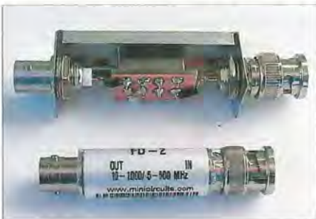
Bild 1: Ansicht eines mit dem Vervielfacher RK-2 von Mini-Circuits aufgebauten Verdopplers (oben) und dem fertig einsetzbaren Verdoppler FD-2 (unten)
