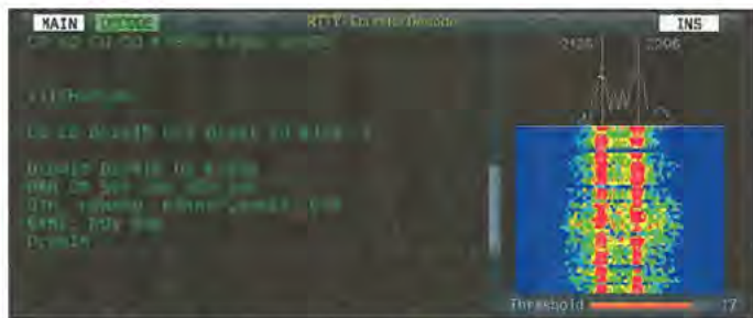
Bild 17: Das FSK-Fenster für den RTTY-Empfang mit derselben Einteilung wie bei PSK
