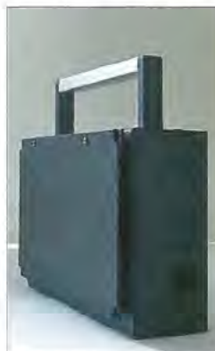
Bild 2: Bei heruntergeklappter Platte ist das Display geschützt und der Einschalt-taster kann nicht betätigt werden. Fotos: DL5KU
