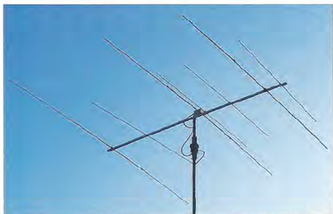
Bild 1: Fertige verschachtelte Zweiband-Yagi-Antenne für 6 m und 10 m im Einsatz bei DH8BQA
