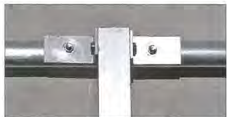
Bild 8: Die Halterung der aus Aluminiumrohren bestehenden Parasitärelemente auf dem eckigen Boom erfolgt mit kleinen Winkeln.
