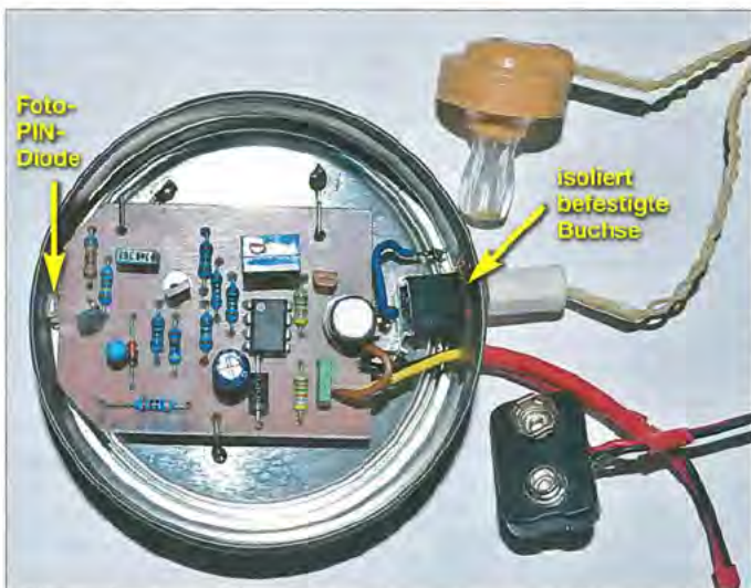
Bild 1: Blick in das geöffnete Gehäuse des Gammastrahlungsdetektors; die als Sensor dienende Foto-PIN-Diode liegt fast direkt an der Innenwand. Die Buchse für den Ohrhörer ist isoliert anzubringen und gegen Lichteinfall abzudichten.
