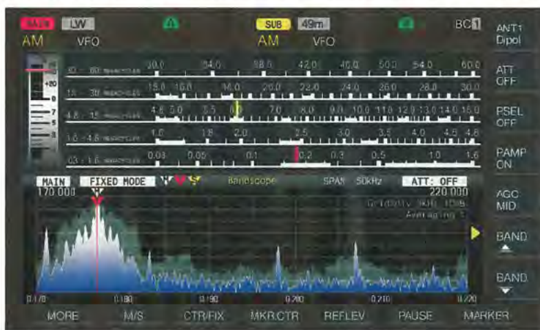
Bild 14: Unter SWL findet sich bei den rechten F-Tasten im Eingangs-menü (Bild 1) dieses Radio für BC-DXer, das sich samt S-Meter am 9R-59 der 60er-Jahre orientiert.
