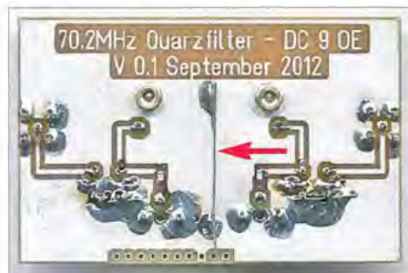
Bild 2: Platinenunterseite mit dem zusätzlich aufgelöteten Abschirmblech
