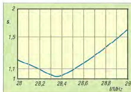
Bild 11: Simuliertes Stehwellenverhältnis der verschachtelten 6-m-/10-m-Yagi-Antenne im Bereich von 28,0 MHz bis 29,0 MHz
