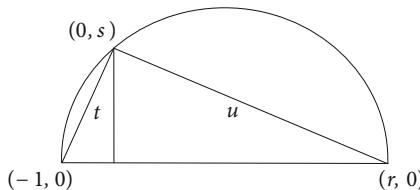
Wir können die Strecke  $\overline{(-1, 0)(r, 0)}$  halbieren und dann den Kreis um diesen Mittelpunkt mit  $\overline{(-1, 0)(r, 0)}$  als Durchmesser konstruieren. Dieser trifft die  $y$ -Achse im Punkt  $(0, s)$ . Somit ist der Punkt  $(0, s)$  konstruierbar. Wir zeigen jetzt, dass  $s = \sqrt{r}$  gilt. Es sind  $s^2 + 1 = t^2$ ,  $s^2 + r^2 = u^2$  und  $t^2 + u^2 = (r+1)^2$ . Also ist  $(r+1)^2 = 2s^2 + 1 + r^2$ , d.h.  $s = \sqrt{r}$ .  $\square$
