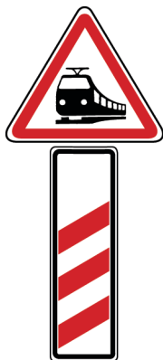
dreistreifige Bake (rechts) – vor unbeschränktem Bahnübergang –
