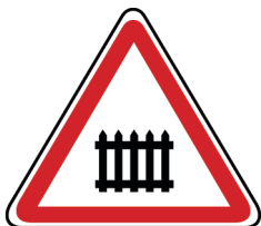
Bahnübergang mit Schranken oder Halbschranken
