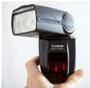
⚡ Externe Blitze lassen sich sowohl vertikal also auch horizontal bewegen, so dass indirektes Blitzen möglich ist.
