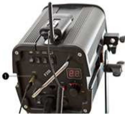
Der Funkempfänger wird per Kabel ❶ mit dem Sync-Eingang des Blitzes verbunden.
