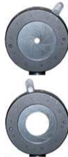
Das Bild zeigt den mechanischen Aufbau einer Blende. Die Lamellen befinden sich im Inneren des Objektivs, und sie werden über einen Motor gemeinsam nach innen oder außen gedreht. Durch die Größe der Öffnung lässt sich die auf den Sensor einfallende Lichtmenge steuern. Die kleine Blendenöffnung (oben) wird mit einer großen Blendenzahl bezeichnet – zum Beispiel f36 – und die große Blendenöffnung unten mit einer kleinen Zahl, etwa f4 (Bild: Michael Häckel).
