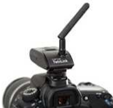
Funksender zum Auslösen des Blitzes wie hier von der Firma Kaiser Fototechnik werden einfach auf den Zubehörschuh der Canon EOS 600D gesteckt.
