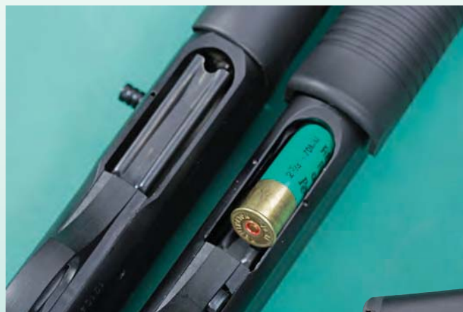
Lademulde und Ladelöffel sind bedienfreundlich, könnten aber an den Kanten stärker abgerundet sein, um den Bedienkomfort zu erhöhen.
