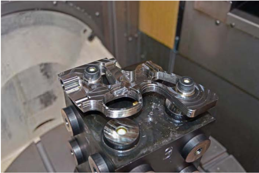
Ein Griffstück in einer Aufspannung nach dem ersten Fräsen.
