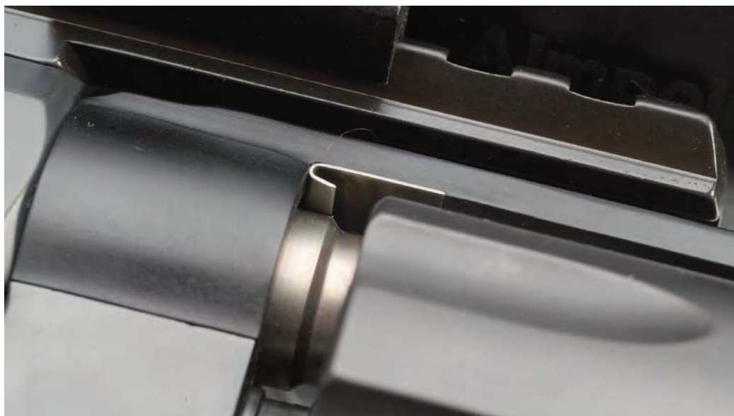
Die Erosion in der Rahmenbrücke lässt sich mit dünnen, mittels Zweikomponentenkleber angebrachten „Opferblechen“ recht einfach in den Griff bekommen.
