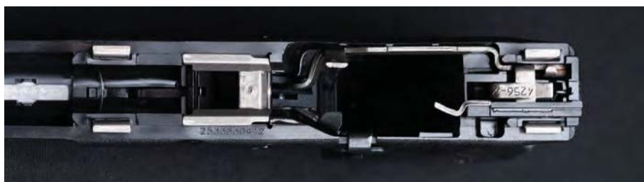
Blick in das übersichtliche, genial-simple Rahmeninnenleben der Glock G20 Gen 4, die wie alle Modelle des Herstellers aus gerade einmal 34 Bauteilen besteht.
