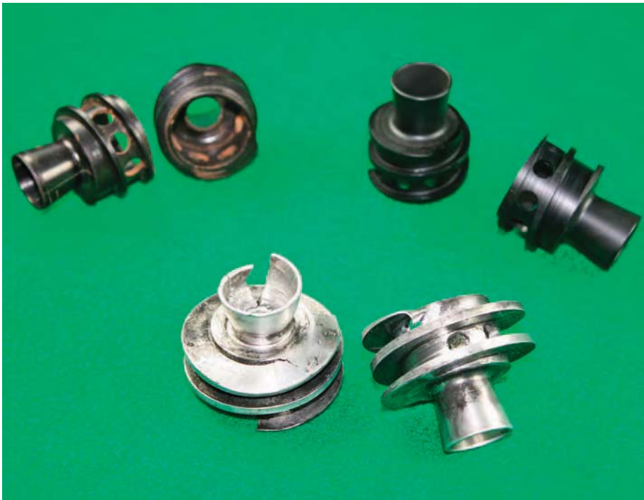
Entwicklung auf Biegen und Brechen: Oben links zwei Originalblenden aus Bakelit, rechts daneben der exakte Nachbau aus Alu, darunter zwei während der Tests zerstörte Blenden. Verformungen, Risse und Absprengungen sind gerade bei stark geladener Langwaffenmunition auf dem Weg der Entwicklung ständige Begleiter und zeigen, welche Kräfte im Inneren des Schalldämpfers wirken.
