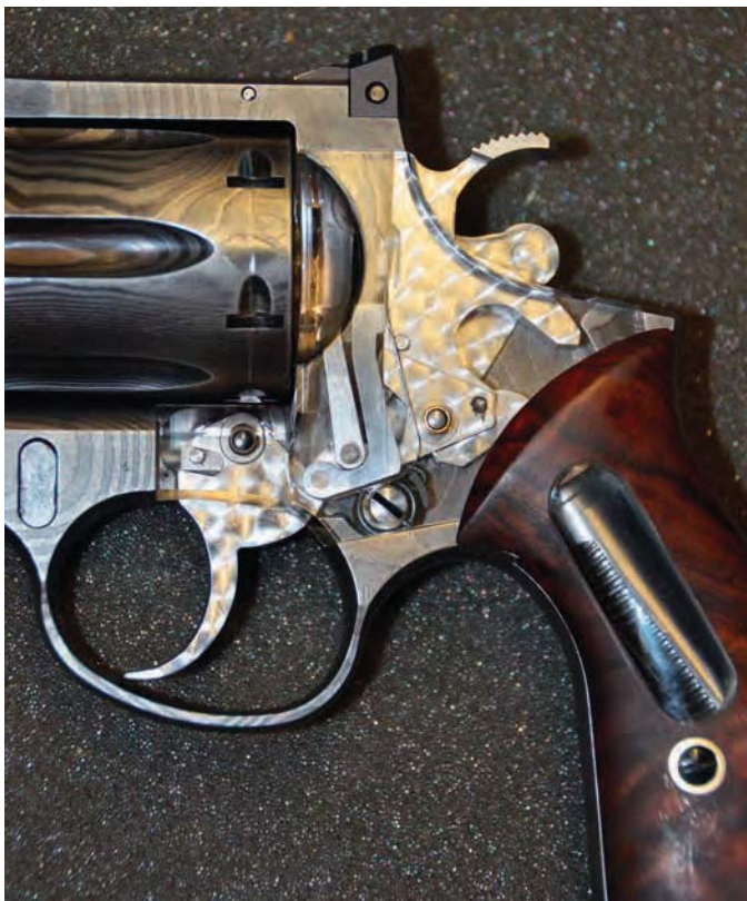
Ein Schnittmodell mit Seitenplatte aus Plexiglas lässt das Schlosswerk mit Druckpunkträdchen für seidenweichen Gang gut erkennen.
