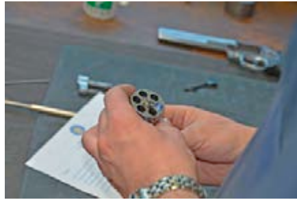
Das Innenprofil und die Mündungspartie des Laufes werden ebenso wie jedes einzelne Patronenlager im Zylinder akribisch visuell kontrolliert.
