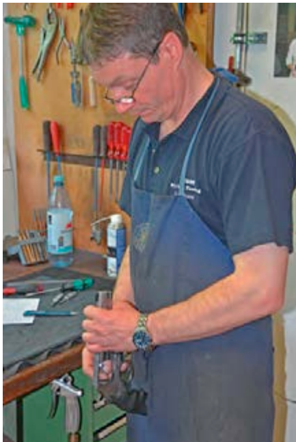
Das Innenprofil und die Mündungspartie des Laufes werden ebenso wie jedes einzelne Patronenlager im Zylinder akribisch visuell kontrolliert.
