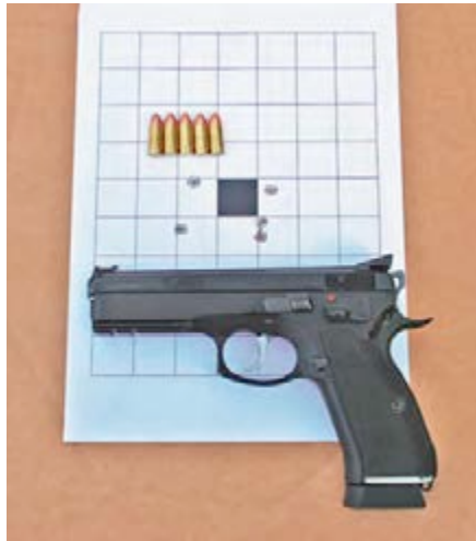
Die 9x19 Handladung mit 4,0 Grains Hodgdon Universal Pulver und 124 Grains GECO FMJ erbrachte einen 57-mm-Streukreis. Faktor: 130.
