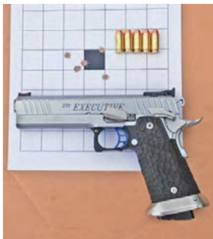
54,5 mm messender Streukreis mit der STI Executive in .40 Smith & Wesson und einer Handladung bestehend aus 6,3 Grains Alliant Power Pistol Treibladungsmittel und 180 Grains GECO FMJ Projektil. Faktor: 177.
