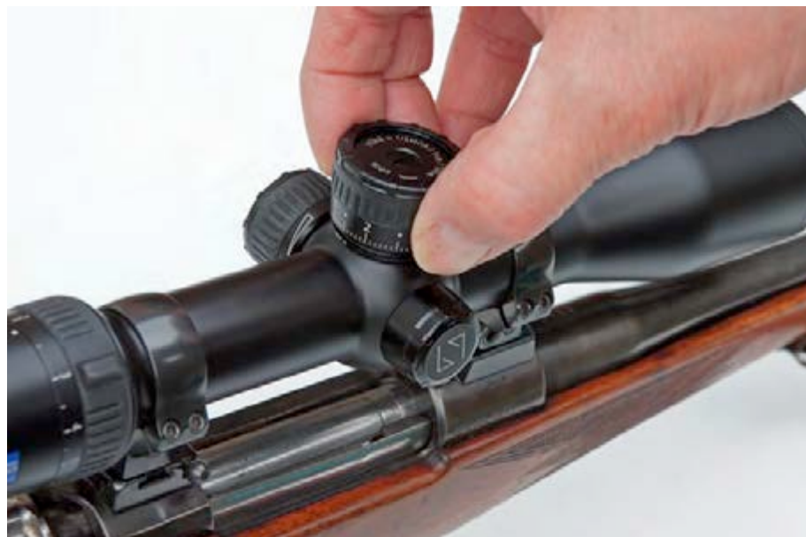
Die Verriegelung des ASV+ Verstellrings am Turm wird aufgehoben, indem man ihn einfach anhebt.
