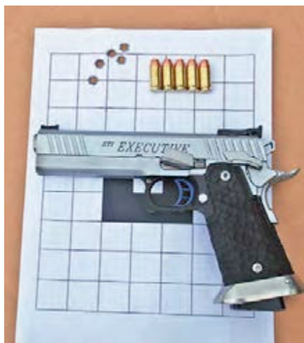
Die .40 S&W Handladung mit 5,0 Grains Hodgdon Titegroup und 180 Grains GECO FMJ produzierte aus der STI 2011 Executive einen Faktor von 175 und einen Streukreis von 41,5 mm.
