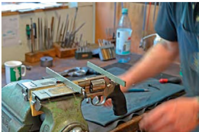
Nach Erfahrungen von Ralf Merkle werden rund 70% aller neuen S&W Revolver mit schief im Rahmen sitzenden Läufen ausgeliefert, was diese Bilder dokumentieren. Hier ist Nachsetzen und Richten angesagt, wenn man Toppräzision anstrebt.
