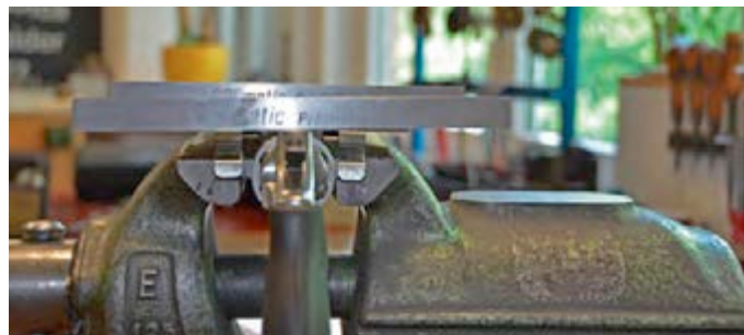
Nach Erfahrungen von Ralf Merkle werden rund 70% aller neuen S&W Revolver mit schief im Rahmen sitzenden Läufen ausgeliefert, was diese Bilder dokumentieren. Hier ist Nachsetzen und Richten angesagt, wenn man Toppräzision anstrebt.
