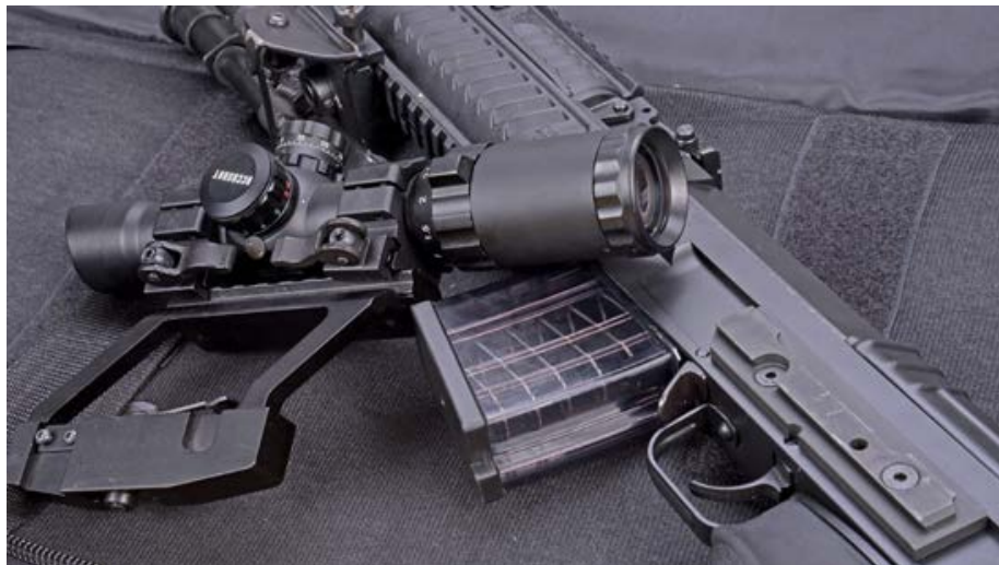
Seitlich am Systemkasten angebrachte Montagsschiene für Optiken.
