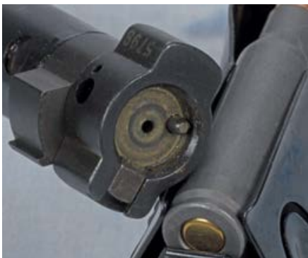
Der klassische Zylinderverschluss mit zwei kräftigen Riegelwarzen im Detail.
