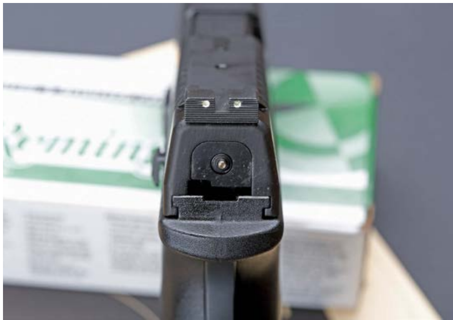
Rückenansicht: Die brauchbare starre Visierung, oberhalb des Signalstiftes in der Verschlussrückseite, der anzeigt, ob die Pistole gespannt ist.
