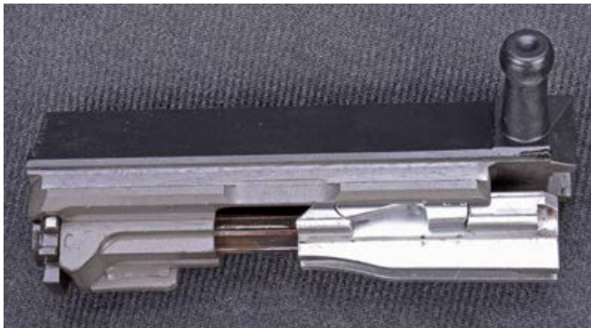
Der VZ58 Schwenkriegelverschluss im entriegelten und verriegelten Zustand.
