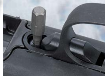
Im Abzugsbügelbereich unter dem Verschlusslösehebel versteckte Systemschraube.
