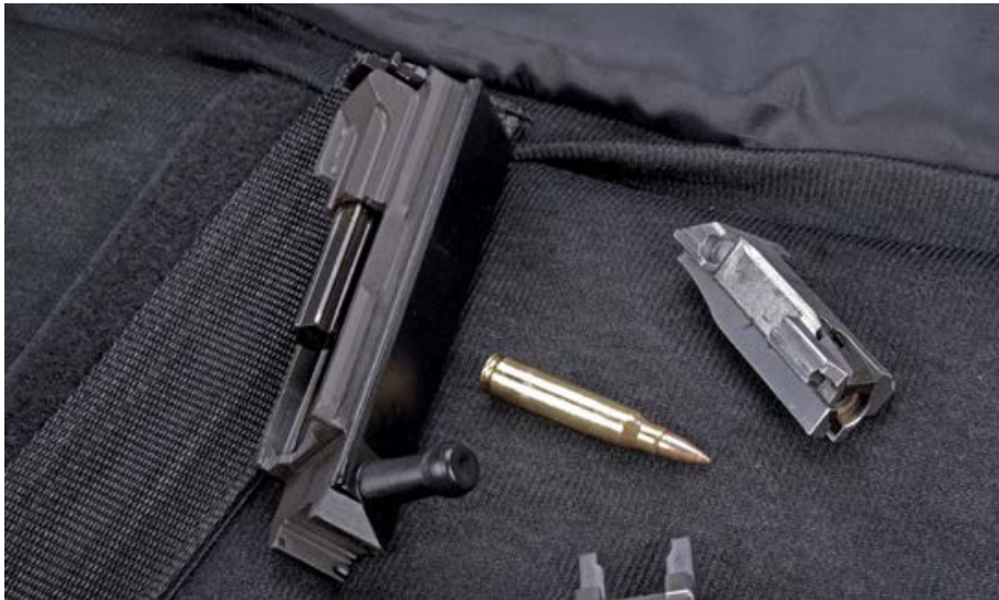
Der Verschluss lässt sich binnen Sekunden in seine Hauptkomponenten zerlegen.
