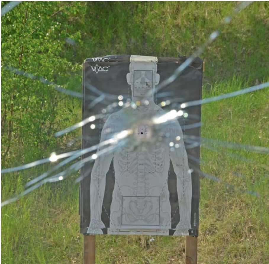
Diese Bilder zeigen die Abweichung, die das Geschoss beim Durchdringen der Windschutzscheibe erfährt. Während der schwarze Punkt im Brustbereich den Haltpunkt und den Durchschuss durch das Glas markiert, findet sich der Treffer weiter oben im Zielmedium wieder.
