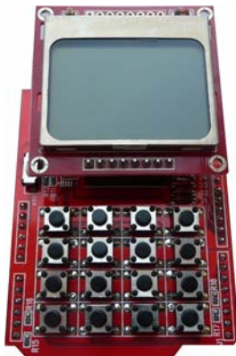
Abbildung 21-22 ► 4×4 Keypad-Shield mit 5110 Display Interface
