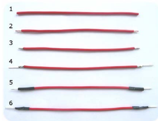
Abbildung 5-10 ► Die einzelnen Phasen bei der Herstellung von flexiblen Steckbrücken
