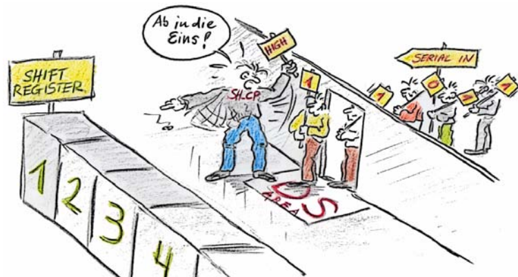
Abbildung 6-2 ► Der Kollege »SH_CP« bei der Abfertigung der seriellen Daten
