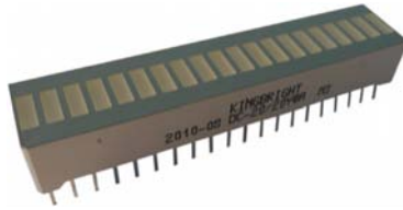
Abbildung 4-6 ► Bar-Graph-Anzeige vom Typ YBG 2000 mit 20 LED-Elementen
