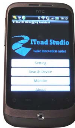
◀ Abbildung 30-1 Das Smartphone mit der Bluetooth-App »ITEAD BT Debugging Assistant«
