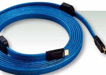
Das „Blue-Water“-HDMI-Kabel gehört zu den derzeit besten HDMI-Kabeln, die man für den Heimbereich kaufen kann. Jedes Kabel trägt eine Seriennummer. Die Innenleiter aus hochreinem Kupfer werden durch eine Schirmung aus Kupfergeflecht und AL/PT-Folie vor äußeren Störeinflüssen geschützt. Die Kontakte der Steckverbinder sind 15 µm dick 24-k-hartvergoldet. Weitere Produkte dieser neuen Kabelserie sollen folgen.
