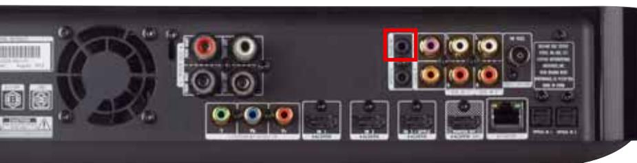
Über den Triggerausgang lässt sich der Subwoofer automatisch mit der Anlage ein- und ausschalten
